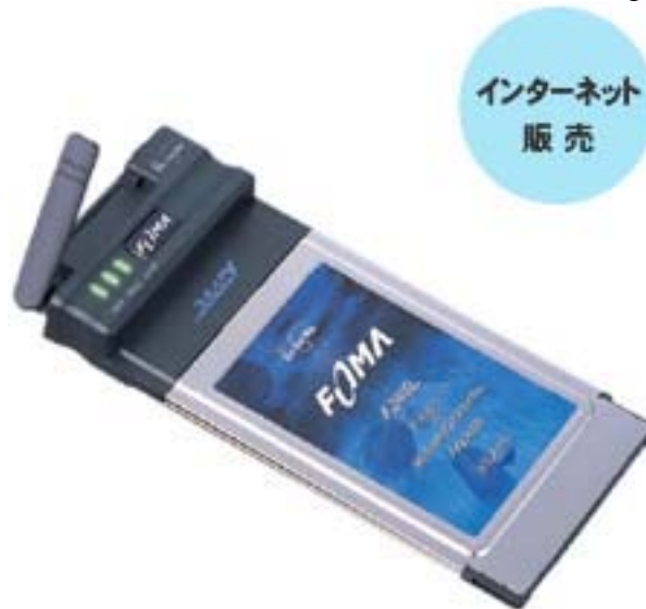
Figure 7 : Carte permettant d'accéder à Internet en utilisant le réseau 3G FOMA (norme WCDMA, débits de 2 Mbps en position fixe et 384 kbps en mobilité)
